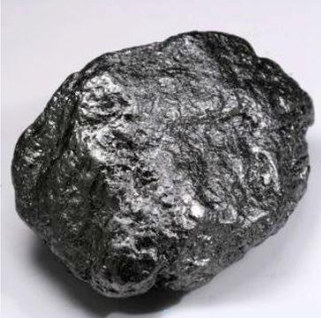
Prodotto del trattamento anaerobico a 1100-1200°C del carbone. Utilizzato in metallurgia. UE importa il 63%, è ancora considerato critico per cautela.
